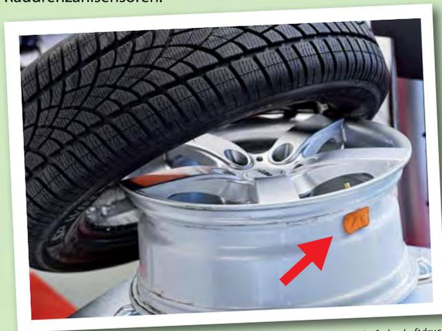
Reifendrucksensoren überwachen dauerhaft den Luftdruck und sorgen so für eine sichere Fahrt.
